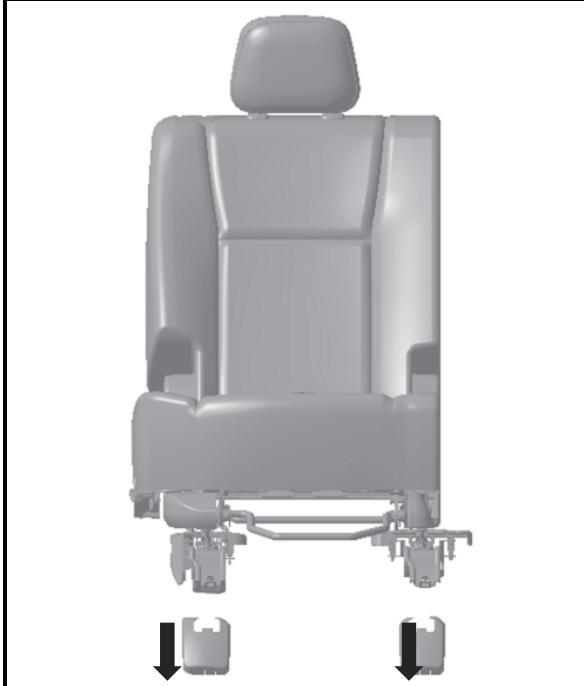
1. 用手取掉前面两个滑轨安装支架装饰件
