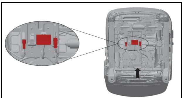
7. 断开车身电源，将座椅稍微向后倾倒，将座椅上的4个接插件与车身上接插件断开。
