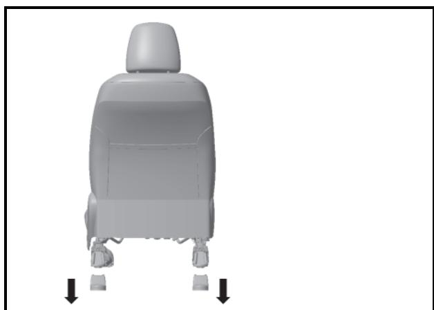
2. 用手取掉后面两个滑轨安装支架装饰件；
