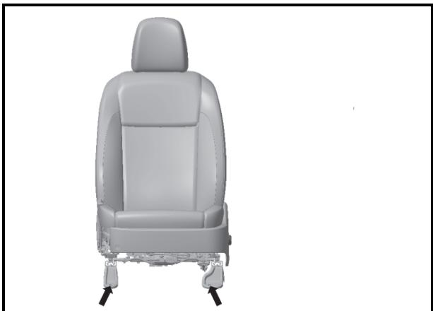
6. 拆卸座椅两个前固定螺栓；
