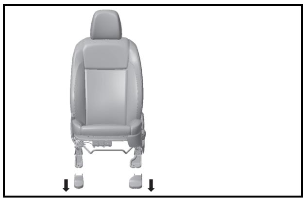
5. 沿图中箭头方向用手取掉前面两个滑轨安装支架装饰件；
