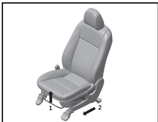
1. 按箭头1处向上提拉滑轨解锁杆，按箭头2方向将座椅移动到最前位置；
