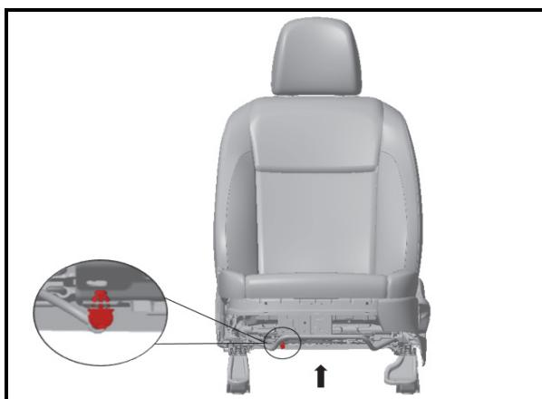
7. 断开车身电源，将座椅稍微向后倾倒，将座椅上接插件与车身上接插件断开。
