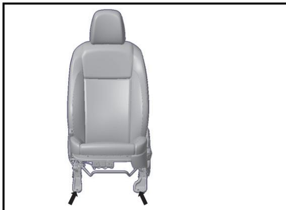
6. 拆卸座椅两个前固定螺栓；
