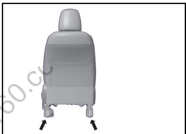
3. 拆卸座椅两个后固定螺栓；
