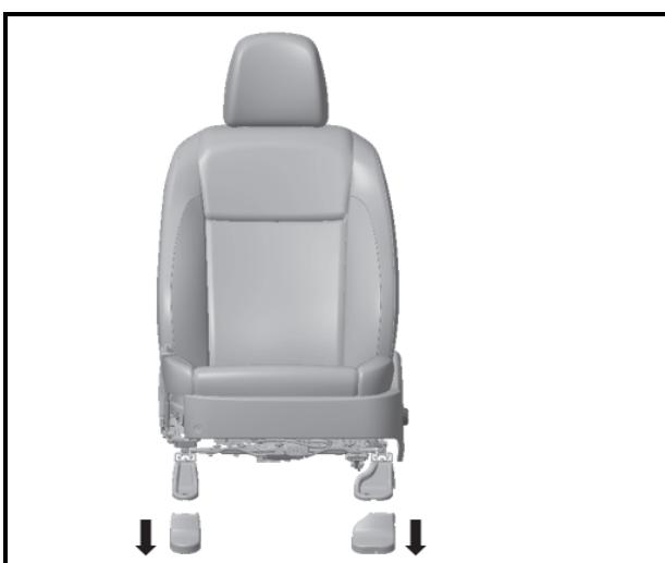
5. 用手取掉前面两个滑轨安装支架装饰件；
